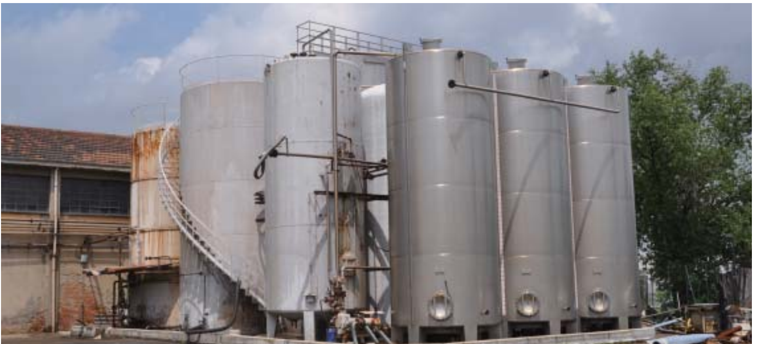
石鹸素地を作る原料を貯蔵しておく巨大タンク（オリーブ油、ヤシ油、等）
